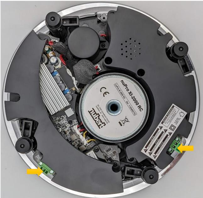
2. Interne Kabelverbindungen trennen (Weiße Steckverbinder mit Verriegelung):
