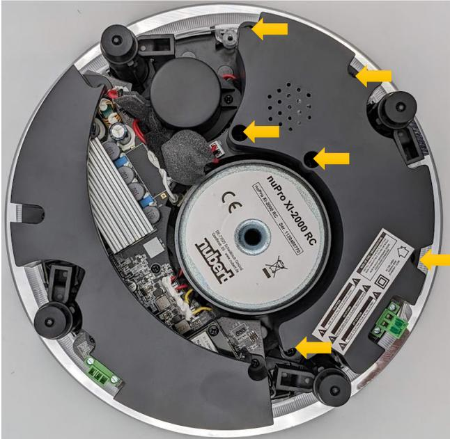
4. Montageschrauben an der Hauptplatine lösen (6 Stück, PH2 Kreuzschlitz, Schwarz). Hauptplatine abnehmen und zur Seite legen. Die Kabel zu den Funkantennen können dabei angeschlossen bleiben. Achten Sie darauf, sie nicht zu beschädigen!
