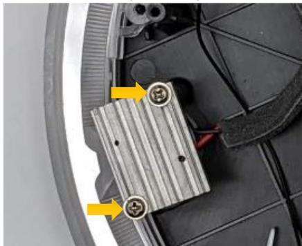
Die Lichtquellen können nun abgenommen werden. Achten Sie darauf, die Kabel der Lichtquelle vorsichtig abzuziehen, um sie und die Lötstellen nicht zu beschädigen!
